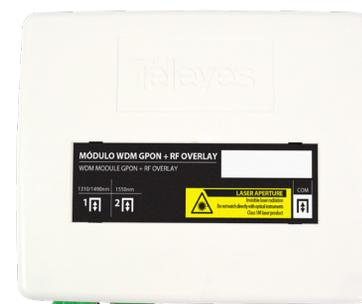
**+** Ce module permet de **multiplexer/démultiplexer** les différentes longueurs d'onde (**Datas en 1310/1490nm & RF Overlay en 1550nm**). Sa principale fonction est de séparer les longueurs d'ondes avant les ONT/ONU (Optical Network Terminal/Unit) et de distribuer les signaux Datas et RF Overlay séparément. Il permet également de mélanger les signaux datas et RF Overlay et d'envoyer deux longueurs d'onde sur **une fibre unique**.
